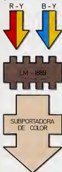
Las señales R-Y y B-Y pasan al chip LM-1889, donde se combinan para convertirse en una señal única.
